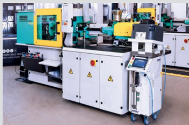
Im Gegensatz zur Schlauchpumpe wird der Schlauch nicht gewalzt und stellt somit kein Verschleißteil dar und muss nicht als Abfall entsorgt werden. Für schnelle Farbwechsel wird das sogenannte Kolben-Set, bestehend aus zwei Schläuchen und dem Kolben, ausgewechselt und für den nächsten Einsatz aufbewahrt. Tropffreie Schnellverschlusskupplungen sorgen dabei für ein sauberes Handling.
