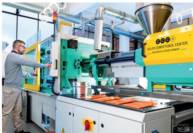
Für die Farbabmusterung werden auf einer 200-t-Spritzgießmaschine DIN A 5 große Prüfplatten (210 mm x 148 mm x 4 mm, Schussgewicht ca. 135 g) hergestellt
