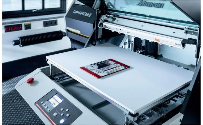
Die individuelle Beschriftung von Farbplatten ist mit der digitalen Flachbettdrucktechnologie möglich © Rowa Group
